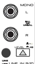
Fig. 2.5: Ingressi del canale stereo, tasto LEVEL e selettore USB/LINE
